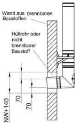
Bei Wänden aus oder mit brennbaren Baustoffen muss bei Durchführung der MKD-Abgasleitung im Umkreis von mind. 7 cm vom Innenrohr gemessen die Durchführung aus nicht brennbaren, formbeständigen Baustoffen geringer Wärmeleitfähigkeit z.B. Leichtbeton hergestellt werden. Der Sicherheitsabstand kann auch durch ein Schutzrohr gewährleistet werden. Er darf auf 5 cm verringert werden, wenn die
